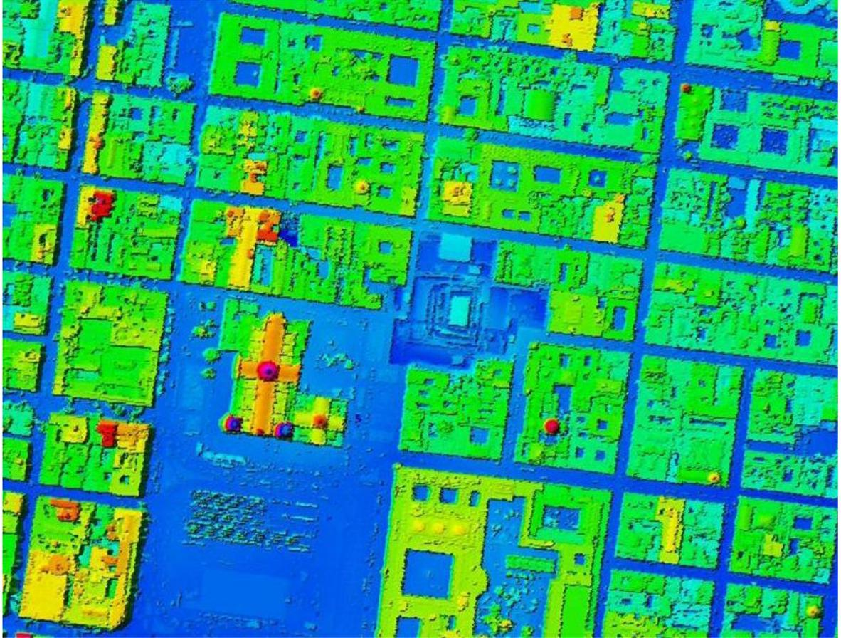
Modelo digital de elevación LiDAR de tipo superficie – Distrito Federal
