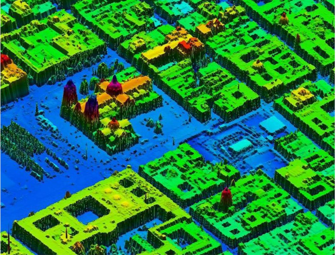
Modelo digital de elevación LiDAR de tipo superficie en perspectiva –
