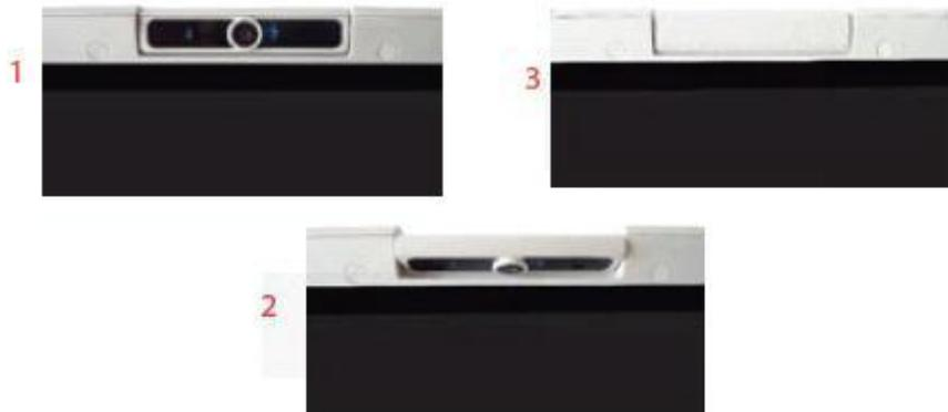
**NOTA:** La cámara giratoria incorporada debe colocarse en la posición original para que el panel de visualización cierre correctamente.
